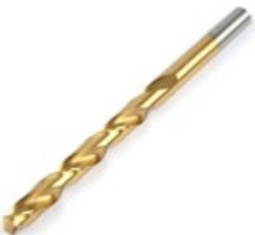
Brocas HSS hechas de acero macizo con recubrimiento de nitruro de titanio (2M) para una vida útil más prolongada. Adecuadas para taladrar en metales, plástico y compuestos. El esmerilado transversal centra de forma automática la broca sin necesidad de utilizar un punzón de centrar. Ángulo de corte de 135°.
