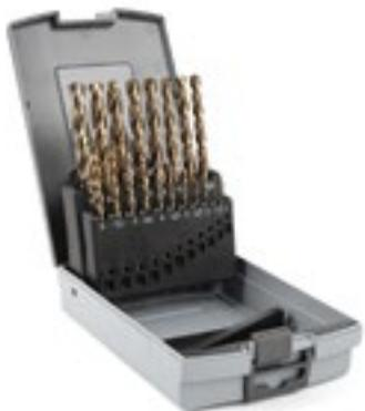
Brocas hechas de acero macizo con gran resistencia a la temperatura y vida útil prolongada gracias a su contenido en aleación de cobalto del 5%. Adecuadas para taladrar en metales, acero inoxidable, plásticos y materiales compuestos. El esmerilado transversal centra de forma automática la broca sin necesidad de utilizar un punzón de centrar. Ángulo de corte de 135°.
