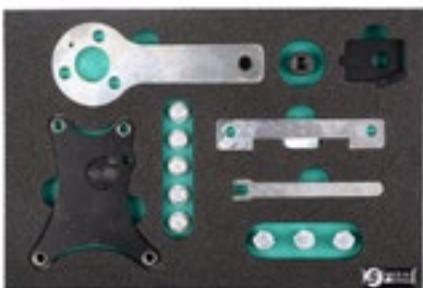
Herramienta de bloqueo para motores de gasolina 1.2 y 1.4 8V. Juego completo para bloqueo de motores y tensado de correas.
