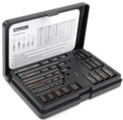
Para retirar tornillos rotos, M5 - M16. Se usa una guía de broca para taladrar un orificio en el tornillo que sigue en el agujero. Este extractor de tornillos se introduce de forma segura en el orificio sin que el tornillo se expanda.
