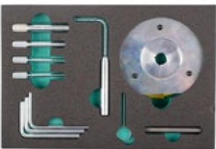
Herramienta de bloqueo para motores diésel Ford Duratorq. Juego completo para bloqueo de motores, levas y bombas. El juego incluye también herramientas para la extracción e instalación de bombas en motores 2.0 y 2.4.
