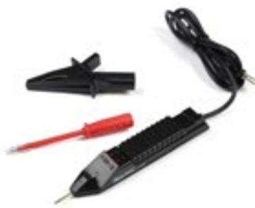
Herramienta de pruebas para el sistema electrónico, 3-48 V. Compatible con componentes eléctricos y electrónicos de vehículos. Dos luces LED indican la polaridad. Punta de contacto y sonda de aguja accionada por resorte para medir a través del aislamiento. Se suministra con un cable de 1,3 m para su uso con una sonda de aguja o pinza de cocodrilo.
