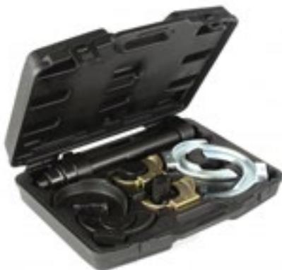
Completo compresor de resorte universal para todas las suspensiones McPherson. Carga máx. de 3,8 toneladas. 3 pares de pinzas de resorte distintas con carrera de 300 mm. Aprobadas para llaves de impacto.
