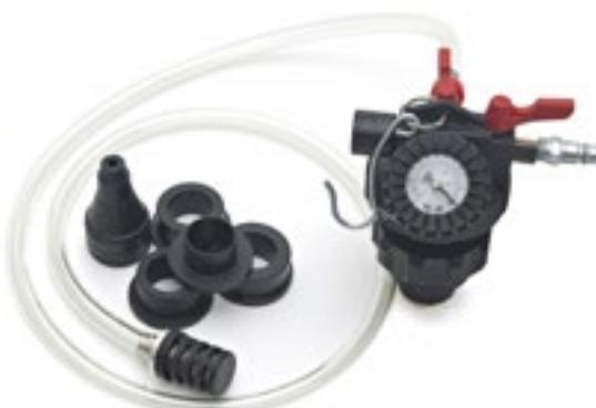
Herramienta eficaz para el llenado del sistema de refrigeración y para la prevención de bolsas de aire. Mediante el uso de aire comprimido, se crea un vacío en el sistema de refrigeración y en el manómetro es posible ver si existe una fuga en el sistema. Suministrado con seis adaptadores útiles para la mayoría de sistemas de refrigeración.
