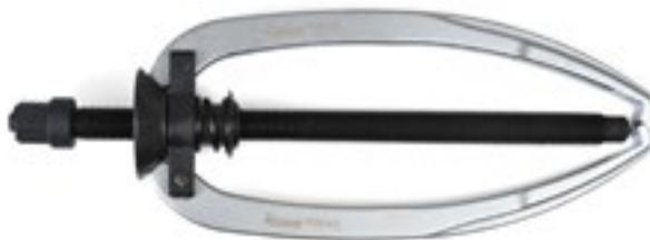
Extractor externo de dos brazos con autocierre. Se puede utilizar con el martillo deslizante K 10173. Pasador de seguridad sustituible que protege contra la sobrecarga.
