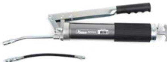
Pistola de engrase extremadamente resistente y adaptada para 400 ml de grasa a granel. La resistente bomba de 2 pistones garantiza un flujo potente incluso con recorridos cortos. Alojamiento de aluminio y piezas metálicas cincadas que evitan la oxidación. La válvula de purga de aire y la válvula de llenado simplifican el llenado a granel. Empuñaduras con goma en el mango de la bomba y el alojamiento, para una mejor adherencia. Se suministra con tubos metálicos y tubos flexibles con boquilla.
