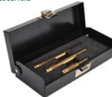
Herramienta de limpieza para la limpieza sencilla de los asientos de las bujías de incandescencia. El juego incluye una herramienta de limpieza para los tres perfiles más comunes de bujías de incandescencia, de modo que cubre la mayoría de vehículos diésel. La herramienta está recubierta con nitrógeno de titanio para un corte y una vida útil óptimos.
