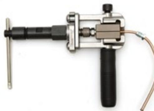
Herramienta hidráulica para el abocardado de tubos de frenos directamente en el vehículo. Para el abocardado sencillo o doble, SAE o DIN. Completo con herramientas, punzón y bocas para tubos de cobre de 4,75, 5 y 6 mm.
