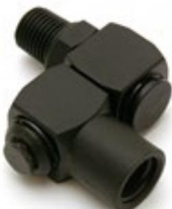
Acoplamiento de aire con giro de 360 grados, fabricado de material compuesto reforzado con aluminio. Roscas NPT 1/4" en ambos extremos. Flujo de aire máx. de 750 litros/minuto.
