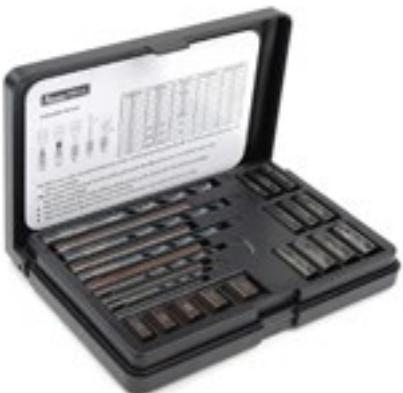
Para retirar tornillos rotos, M5 - M16. Se usa una guía de broca para taladrar un orificio en el tornillo que sigue en el agujero. Este extractor de tornillos se introduce de forma segura en el orificio sin que el tornillo se expanda.
