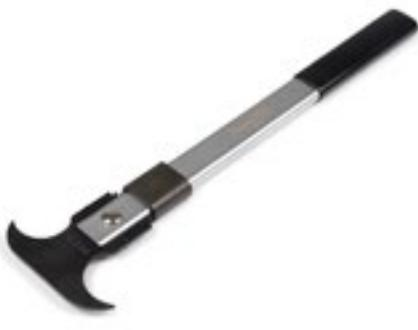
La herramienta que hace mucho más fácil la extracción de sellos. Dos tamaños de ganchos y un cabezal, que se puede ajustar en cinco posiciones, le permiten adaptarse a la mayoría de los sellos. Además, el cabezal ajustable aumenta la accesibilidad para, por ejemplo, poder acceder al sello de un cigüeñal frontal o a los ejes transversales de los vehículos con tracción delantera.
