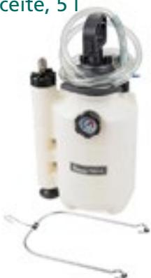
Para llenar de aceite cajas de cambios, diferenciales, etc. Llenados rápidos, sencillos y controlados. Suministrado con manómetro y soporte de enganche. Funciona utilizando sobrepresión para bombeo hasta 1,7 bar como máximo. Se puede utilizar con un juego de conductos de llenado o con conductos de llenado independientes como complemento.
