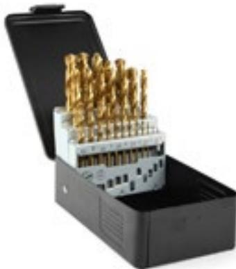
Brocas HSS hechas de acero macizo con recubrimiento de nitrógeno de titanio (2M) para una vida útil más prolongada. Adecuadas para taladrar en metales, plástico y compuestos. El esmerilado transversal centra de forma automática la broca sin necesidad de utilizar un punzón de centrar. Ángulo de corte de 135°.
