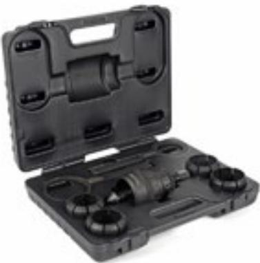
Al desmontar un cubo de rueda, la pista interna del rodamiento permanece con frecuencia en el eje. Esta herramienta se ha desarrollado para retirar la pista interna de rodamiento con rapidez y eficacia. Algunos métodos en los que se utilizan rectificadores, cinceles o soldadura por gas aumentan el riesgo de sufrir lesiones. El juego de herramientas se puede utilizar para retirar las pistas internas de rodamientos con diámetros de entre 40 y 61 mm.
