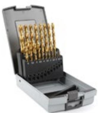
Brocas HSS hechas de acero macizo con recubrimiento de nitruro de titanio (2M) para una vida útil más prolongada. Adecuadas para taladrar en metales, plástico y compuestos. El esmerilado transversal centra de forma automática la broca sin necesidad de utilizar un punzón de centrar. Ángulo de corte de 135°.
