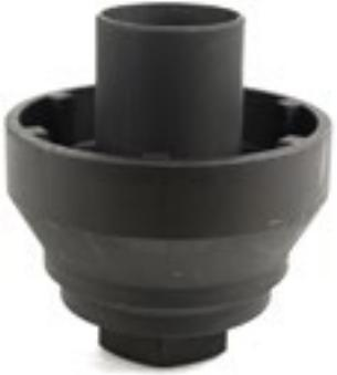
Vaso para contratuerca en ejes TGA. 133-145 mm con boca de 60 mm y 6 puntas.
