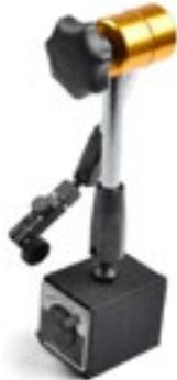
Base magnética para el manómetro de presión . Dos juntas esféricas ajustables con un solo mando. Ajuste de precisión de la posición del manómetro de presión. Encaja en el manómetro de presión con un accesorio de 8 mm. Fuerza de los imanes: 60 kgSoporte inferior: 176 mmSoporte superior: 150 mm
