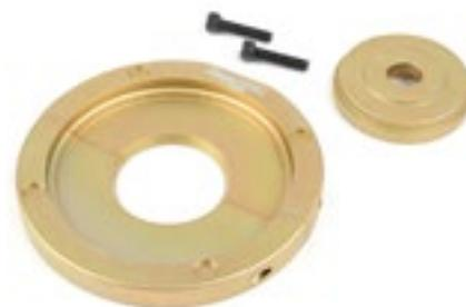
Dado que los cojinetes y los cubos de cojinetes están ahora integrados, se requieren herramientas especiales para evitar dañarlos. Este juego se puede utilizar para extraer cojinetes de 82 mm de diámetro. Se utiliza junto con el cilindro hidráulico K 22500 o el juego básico K 10598.
