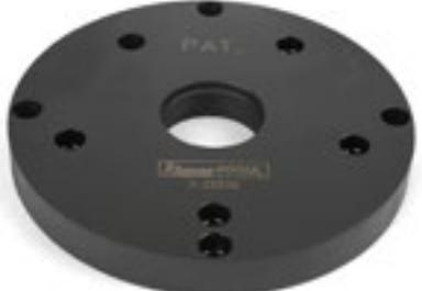
Placa de presión para cojinetes de rueda de 2.ª generación. Se utiliza junto con el cilindro hidráulico K 22500 y el extractor para cojinetes de rueda de 2.ª generación. Rosca interior, 2 1/4"-14 UNS.
