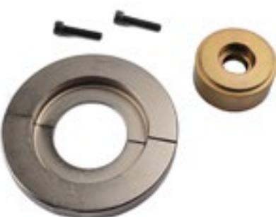
En muchos automóviles nuevos, los cojinetes y cubos de rueda están ensamblados formando una sola unidad. En estos casos se precisan herramientas especiales para evitar dañar el cojinete. Este juego puede utilizarse para insertar cojinetes de 66 mm de diámetro. Uso en combinación con el juego básico K 10347/ K 22508.
