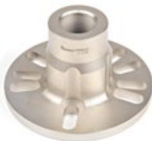
Cubo de ruedas para extractor. 10 orificios, realizados para 3, 4 y 5 cubos de ruedas, rosca M38, utilizada en combinación con el martillo deslizante K 10190 + K 10191 + K 10192 o el cilindro para prensa hidráulica K 10194.
