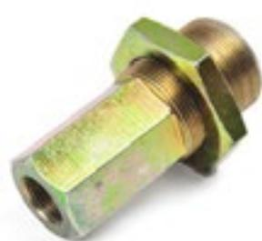
Adaptador para su utilización entre el martillo deslizante y el disco del extractor con una rosca M20/M38. Utilizado en combinación con el martillo deslizante K 10190 y el disco para cubos de ruedas K 10189.
