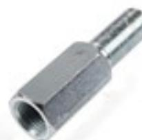
Adaptador de la herramienta para inyectores; la rosca hembra 5/8" para rosca macho M16 x 1,5 también permite utilizar el martillo de impacto K 448 para la herramienta para inyectores roscados M16 x 1,5. Fabricado con acero al carbono endurecido y galvanizado (S45C).
