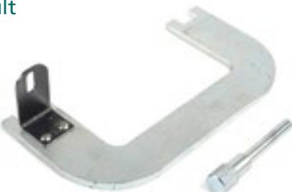
Herramienta de bloqueo para motores Renault 2.0 IDE de gasolina. Juego completo para bloqueo de motores y control de PMS.
