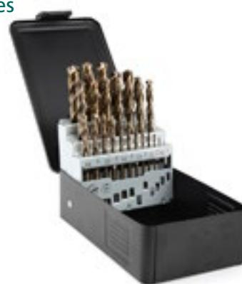
Brocas hechas de acero macizo con gran resistencia a la temperatura y vida útil prolongada gracias a su contenido en aleación de cobalto del 5%. Adecuadas para taladrar en metales, acero inoxidable, plásticos y materiales compuestos. El esmerilado transversal centra de forma automática la broca sin necesidad de utilizar un punzón de centrar. Ángulo de corte de 135°.
