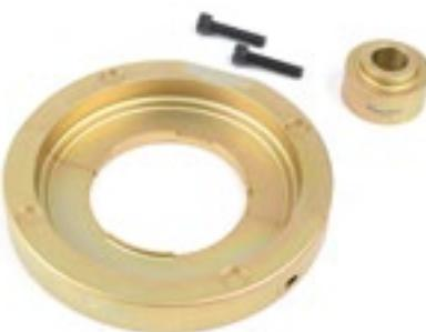
Dado que los cojinetes y los cubos de cojinetes están ahora integrados, se requieren herramientas especiales para evitar dañarlos. Este juego se puede utilizar para extraer cojinetes de 82 mm de diámetro. Se utiliza junto con el cilindro hidráulico K 22500 o el juego básico K 10598.
