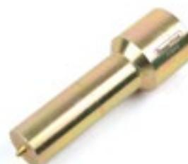
Pieza de presión para extraer ejes de transmisión. Pasador de 20 mm de diámetro. Se utiliza como parte de los accesorios del cilindro hidráulico K 22500.
