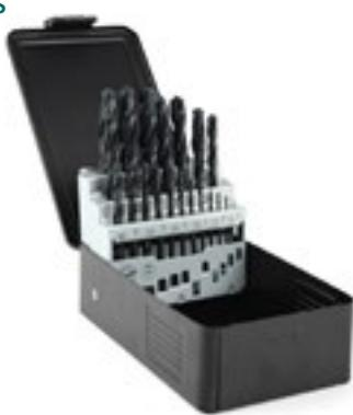
Brocas HSS-R laminadas en caliente y endurecidas al vapor con ángulo de corte de 118°. Adecuadas para taladrar en metales, plástico y compuestos.
