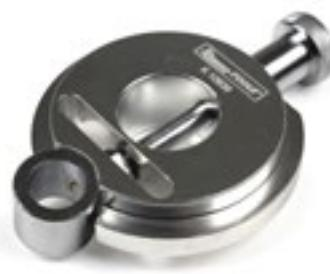
Esta herramienta permite ajustar los ángulos de caída del conjunto del eje delantero de forma rápida y precisa. Los ángulos de caída se ajustan mediante la alineación cuidadosa de los puntos de fijación superiores del puntal de muelle. Realizar un ajuste profesional y preciso de los ángulos de caída es casi imposible sin la ayuda de esta herramienta.
