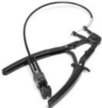
Para montar y desmontar abrazaderas de tubos flexibles con acción de resorte y extremos en punta en motores VAG 2.0 TDI modernos: BKD. Entre otros, VW Passat de 2005, Touran, Golf V, SKODA Octavia, AUDI A3. Aptos, en especial, para el tubo flexible inferior del radiador de difícil acceso, con el alambre flexible de 630 mm. Diámetro máx. de abrazadera: 55 mm
