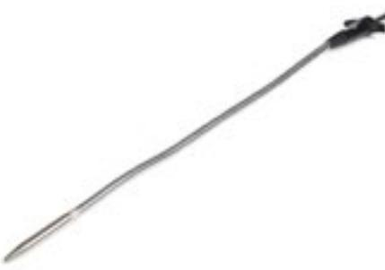
Las herramientas recogedoras constituyen una eficaz ayuda a la hora de acceder a tornillos, arandelas, etc., en lugares de difícil acceso. Las herramientas disponen de un brazo flexible de 500 mm de largo y tres pinzas con un mango de 27 mm de ancho.
