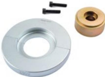
En muchos automóviles nuevos, los cojinetes y cubos de rueda están ensamblados formando una sola unidad. En estos casos se precisan herramientas especiales para evitar dañar el cojinete. Este juego puede utilizarse para insertar cojinetes de 62 mm de diámetro. Uso en combinación con el juego básico K 10347 / K 22508. Se adapta, entre otros, a: Audi A2 00 y posteriores / VW Lupo 99 y posteriores
