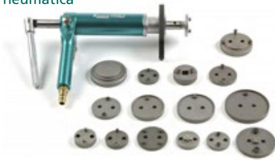
Juego completo para la retracción de los pistones de frenos sin dañar los pistones o los guardapolvos de goma. El juego contiene una herramienta básica con un cilindro de aire comprimido que expulsa un cojinete suministrado con 15 adaptadores. Para mordazas atornilladas a la izquierda o a la derecha.
