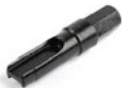
Diseñada para su uso con vasos de 6 caras, 1/4". Adecuada para tapones de aceite de motores de 4 cilindros de 3.ª generación (vehículos VAG), por ejemplo, Golf VII, Audi o Seat León. También para tapones de carcasa de levas en motores diésel 1.6 y 2.0 con doble árbol de levas (vehículos VAG). Equivalente a OEM T10549.
