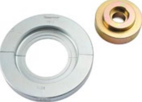
En muchos automóviles nuevos, los cojinetes y cubos de rueda están ensamblados formando una sola unidad. En estos casos se precisan herramientas especiales para evitar dañar el cojinete. Este juego puede utilizarse para insertar cojinetes de 72 mm de diámetro. Uso en combinación con el juego básico K 10347/ K 22508.
