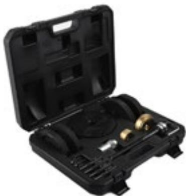
Para la instalación y extracción segura de cojinetes de rueda de 78 mm de la generación II. En muchos automóviles nuevos, los cojinetes y cubos de rueda están ensamblados formando una sola unidad. En estos casos se precisan herramientas especiales para evitar dañar el cojinete. Este juego puede utilizarse para extraer e insertar cojinetes de 78 mm de diámetro. Se adapta, entre otros, a: Ford Focus 04 y posteriores / Mazda 3 03 y posteriores / Volvo C30, C70, S40, V50
