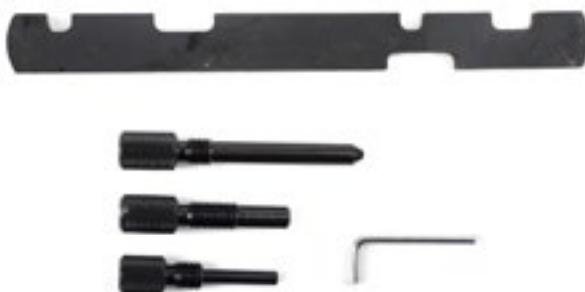
Herramienta de bloqueo para motores Ford 1.25, 1.4 y 1.6 de gasolina, y Volvo 1.8 y 2.0 de gasolina, así como para Volvo C30, S40, V50 y V70 1.6. Motores 1.8, 2.0: B4184S8, B4184S11, B4204S3, B4204S4. Juego completo para bloqueo de motores y tensado.
