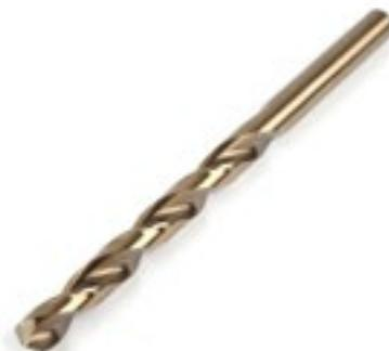
Brocas hechas de acero macizo con gran resistencia a la temperatura y vida útil prolongada gracias a su contenido en aleación de cobalto del 5%. Adecuadas para taladrar en metales, acero inoxidable, plásticos y materiales compuestos. El esmerilado transversal centra de forma automática la broca sin necesidad de utilizar un punzón de centrar. Ángulo de corte de 135°.
