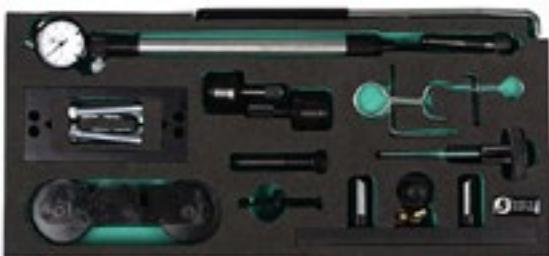
Herramienta de bloqueo para motores de gasolina de VAG, incluidos los motores FSi y TFSi. 1.4, 1.6, 2.0, 2.4 & 3.2. Juego completo para bloqueo de motores, levas y control de PMS.
