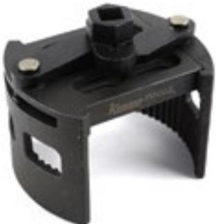
Desarrollado para extraer filtros de aire difíciles de desmontar en sistemas de freno de vehículos pesados. Puede utilizarse para diámetros comprendidos entre 104 y 150 mm. Puede utilizarse asimismo para desmontar e instalar filtros de aceite. La herramienta se acciona por resorte y posee un vástago de 1/2" o un accionamiento de 6 caras, 24 mm.
