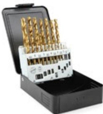
Brocas HSS hechas de acero macizo con recubrimiento de nitrógeno de titanio (2M) para una vida útil más prolongada. Adecuadas para taladrar en metales, plástico y compuestos. El esmerilado transversal centra de forma automática la broca sin necesidad de utilizar un punzón de centrar. Ángulo de corte de 135°.
