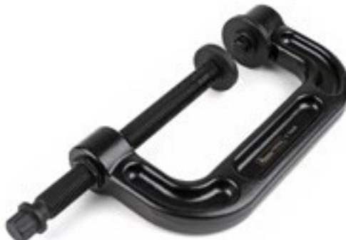
Para retirar y montar pernos de rótula y casquillos sin agujeros, etc. Se puede utilizar con una llave de impacto. Compatible con los vasos del juego K 10188, el cilindro para prensa hidráulica K 10194, la extensión K 10197 y K 10198 y el vaso de centrado K 10199.
