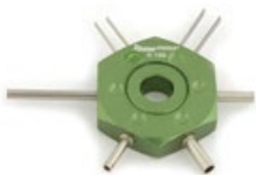
Para el montaje y desmontaje de pasadores redondos y planos en piezas de contacto.
