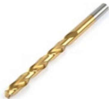
Brocas HSS hechas de acero macizo con recubrimiento de nitrógeno (2M) para una vida útil más prolongada. Adecuadas para taladrar en metales, plástico y compuestos. El esmerilado transversal centra de forma automática la broca sin necesidad de utilizar un punzón de centrar. Ángulo de corte de 135°.
