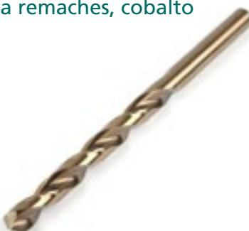
Brocas hechas de acero macizo con gran resistencia a la temperatura y vida útil prolongada gracias a su contenido en aleación de cobalto del 5%. Adecuadas para taladrar en metales, acero inoxidable, plásticos y materiales compuestos. El esmerilado transversal centra de forma automática la broca sin necesidad de utilizar un punzón de centrar. Ángulo de corte de 135°.
