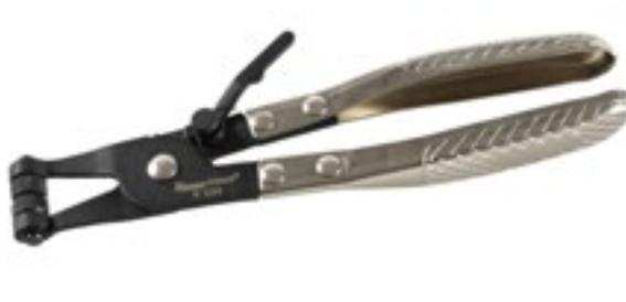
Alicates con función de bloqueo para la instalación y extracción de abrazaderas de sujeción de tubos flexibles de resorte. Las mordazas son articuladas para facilitar el acceso. Mordazas con ranura en V.
